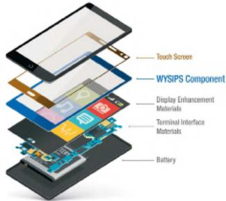
Combinant les technologies optiques et photovoltaïque, son principe révolutionnaire est un composant autoproducteur d'électricité d'origine lumineuse, naturelle et artificielle. Ultrafin et transparent, il s'intègre dans les écrans. Wysips® Crystal optimise tous les types d'appareils : mobiles standards et smartphones, tablette, e-readers, etc. Il s'adapte à toutes les technologies d'écran : MEMMS, bi-stable, LCD, OLED, optical screen, etc...
